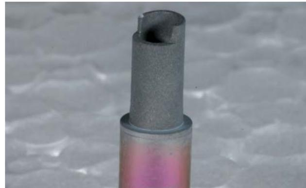
Abb. 10: Die abgestrahlte Titanbasis wird zum Kleben vorbereitet.
