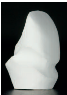
Abb. 14 Der Prototyp wurde mit einem Kopierfräser auf einen ZrO 2 -Weißling übertragen. Dieser wird nach dem Kopierfräsen geglättet und labial, auf Gingivaniveau, mit einer Hohlkehle für die Keramikschulter versehen
